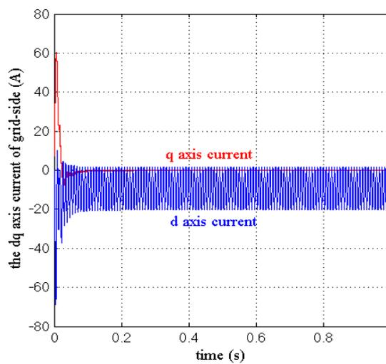
Figure 13. The dq axis current of grid side
